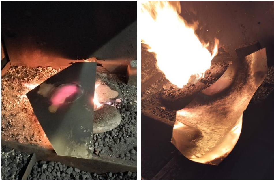
Obr. 32 a 33 Vykúvanie brušného plátu na predný plat kyrisu
