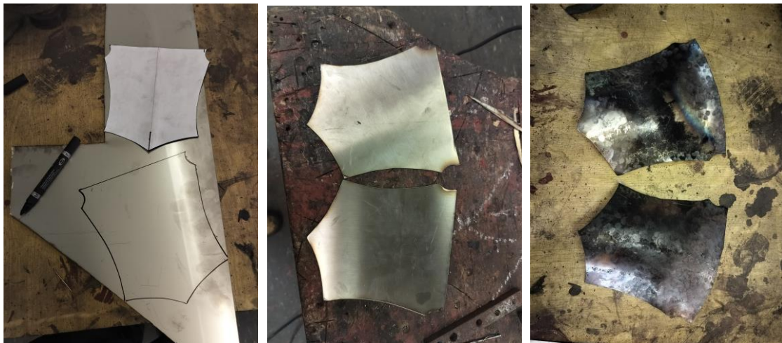
Obr. 34,35 a 36 Výtápávanie ochranných štítkov na predný plat kyrisu
