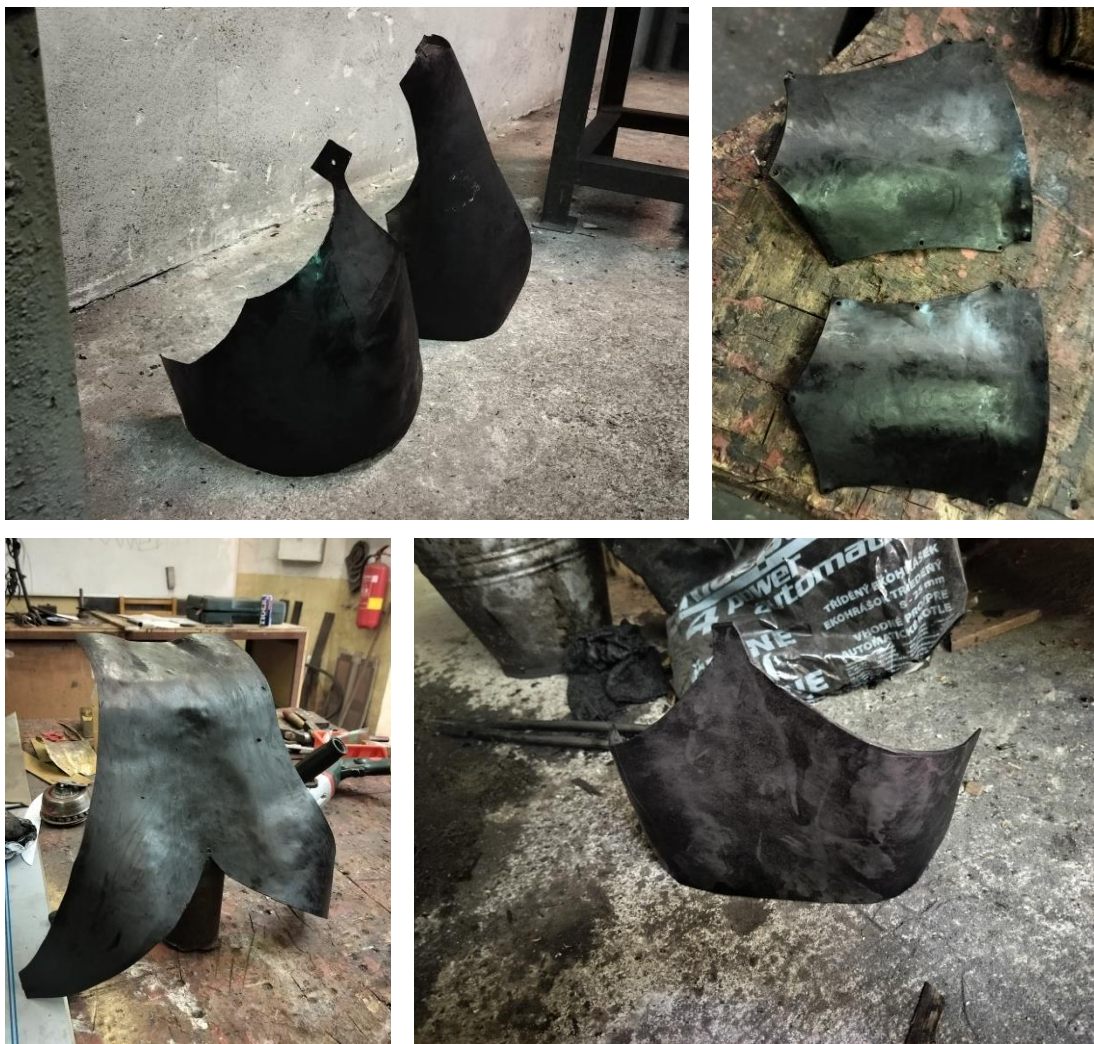
Obr. 39,40,41 a 42 Výsledky čiernenia hlavných plátov kyrisu
