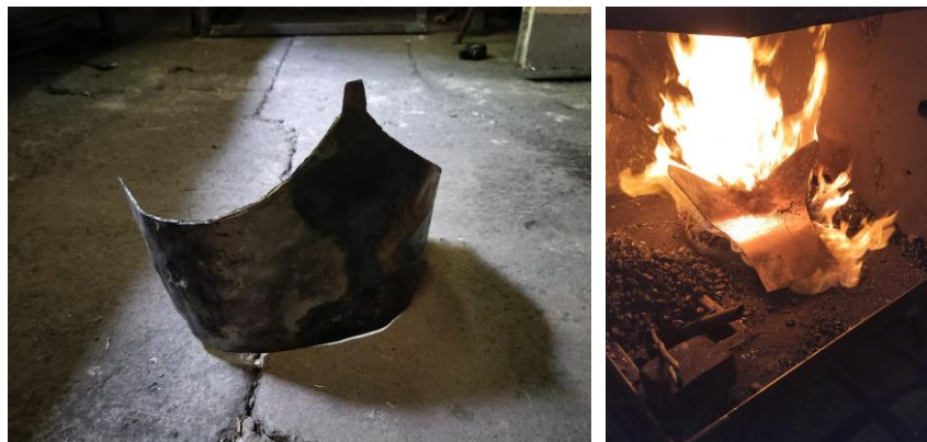
Obr. 37 a 38 Vykúvanie spodného a horného plechu zadnej časti kyrisu
